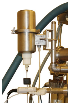
De Ceramax CPS341D is gemaakt van staal met een coating van onbreekbaar pH-gevoelige emaille.
