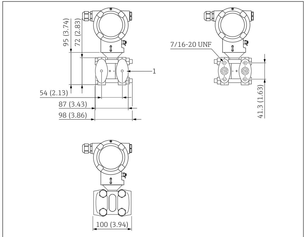
4 Vue de face, vue du côté gauche, vue du côté droit. Les écrous se trouvent toujours du côté négatif. Unité de mesure mm (in)
